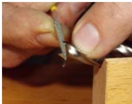
**6/** Vorschneider an hochwertigen Holzbohrern sind so geformt, dass sie die Holzfasern zu den Schneidlippen hin ziehen. Wenn man sie von innen mit einer Diamant-Flachspitze feile vorsichtig nachschärft ist darauf zu achten, dass die Spitzen erhalten bleiben.
