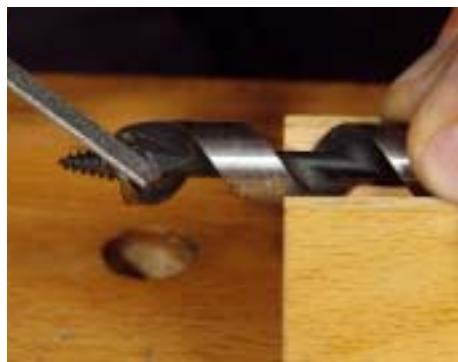
**3/** Beim Schlangenbohrer werden die Schneidfasen mit einer schmalen Diamant-Flachfeile geschärft, wobei der Bohrer in einem genuteten Holzblock liegt. Der Vorschneider wird nur von innen mit einem messerförmigen Abziehstein nachgeschärft.
