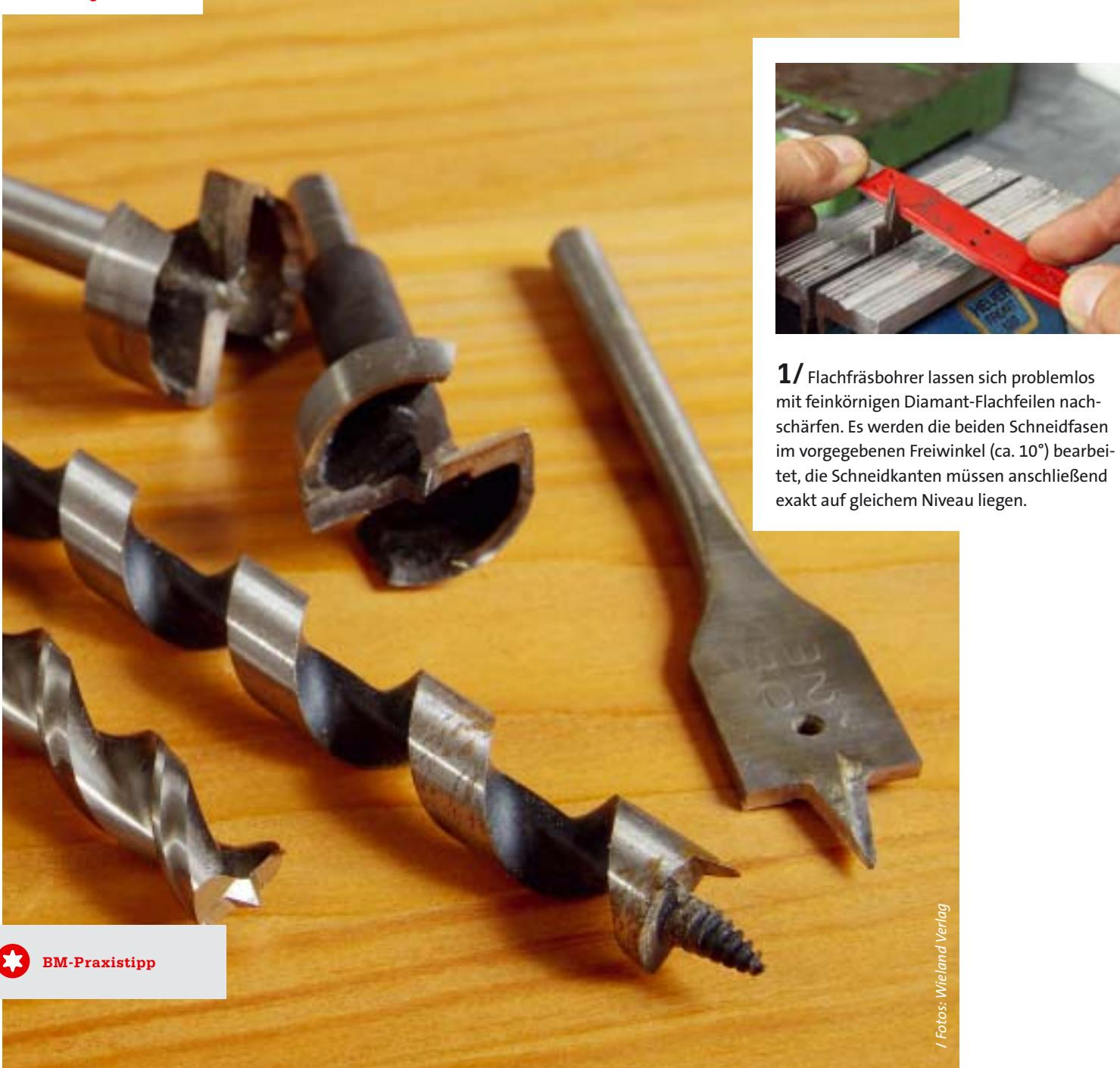
**1/** Flachfrässbohrer lassen sich problemlos mit feinkörnigen Diamant-Flachfeilen nachschärfen. Es werden die beiden Schneidfasen im vorgegebenen Freiwinkel (ca. 10°) bearbeitet, die Schneidkanten müssen anschließend exakt auf gleichem Niveau liegen.
