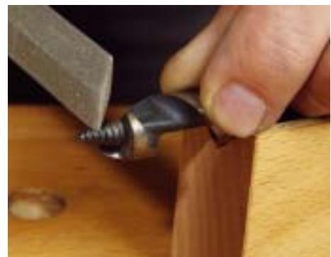
**4/** Verschlissene Gewindegänge der Schraubspitze kann man mit einem scharfkantigen Abziehstein oder einer rautenförmigen, schlanken Diamantfeile (Sägenfeile) nacharbeiten.
