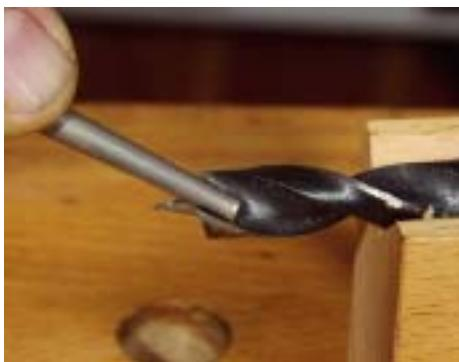
**5/** Der einfache Holzspiralbohrer (ohne Vorschneider) wird mit einem quadratischen Schleifstift an den beiden Schneidfasen nachgeschärft. Bei geringem Verschleiß genügt es, die Schneidlippen mit einer Diamant-Rundfeile an den Spannuten nachzuarbeiten.
