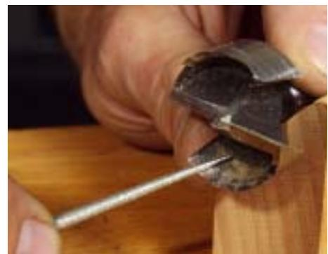
**7/** Gerade und wellenförmige Umfangsschneiden von Forstnerbohrern werden mit einem runden Schleifstift längs zur Schneide nur von innen geschärft. Die beiden Hauptschneiden werden von oben und unten mit einem flachen Schleifstift bearbeitet.
